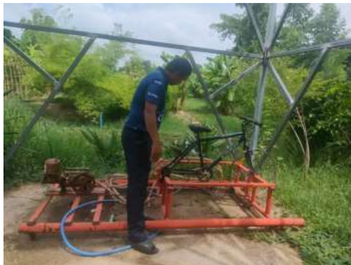
ภาพประกอบที่ ๙ เครื่องปั้มน้ำจากแนวคิดประดิษฐ์
