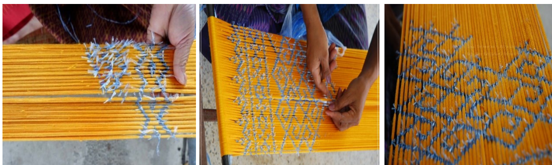
รูปภาพที่ ๔.๑๒ แสดงกระบวนการและขั้นตอนการมัดหมี่
