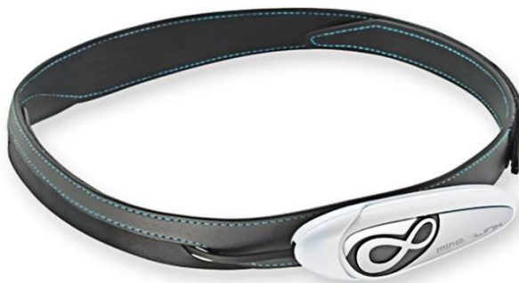
ภาพที่ ๓.๑ เครื่องวัด Mindlink อุปกรณ์ EEG อัจฉริยะสวมใส่ได้
